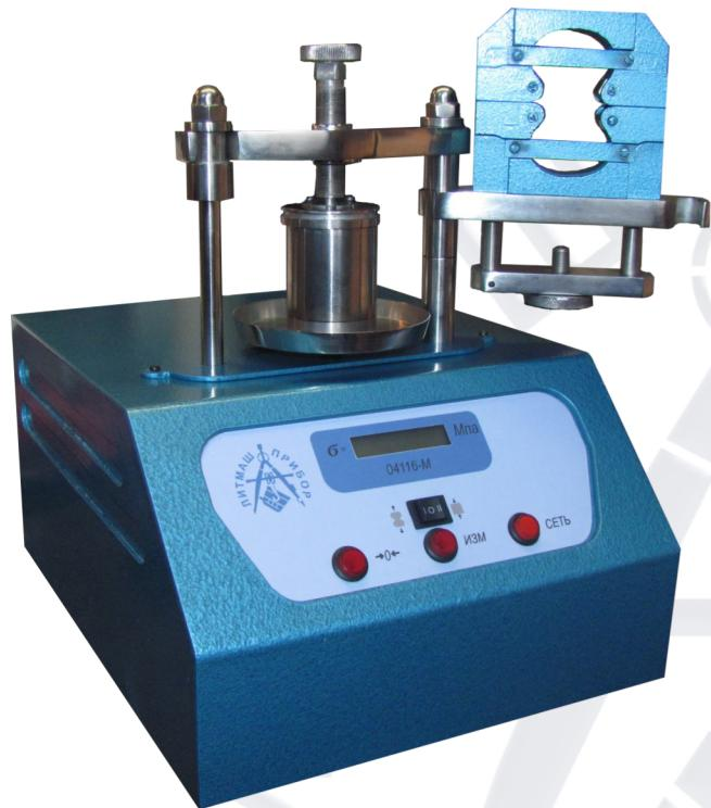
Машина предназначена для определения предела прочности и растяжение формовочных и стержневых смесей в сухом или отверженном состоянии в соответствии с ГОСТ 23409,7-78.
